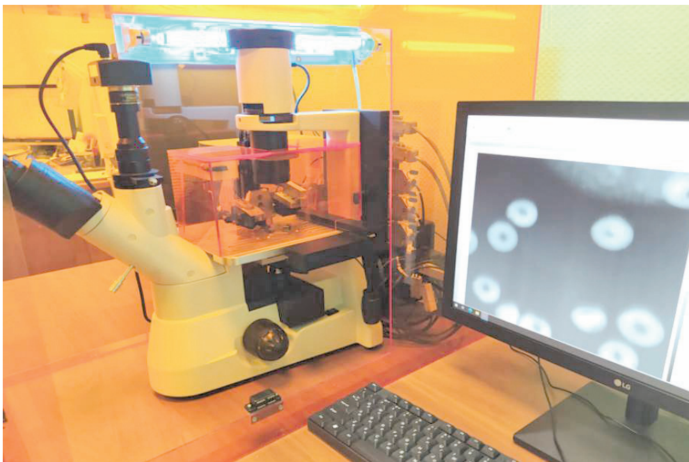
Рис. 4. Общий вид комплекса в РНПЦ по животноводству с дополнительной камерой терморегуляции и системой УФ-стерилизации рабочей зоны, сканер АСМ повернут на 90° к оси флуоресцентного микроскопа
