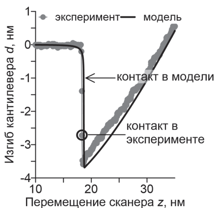
Рис. 1. Начальный участок взаимодействия зонда CSG30 с поверхностью полиуретана: расчет модели и типичная экспериментальная кривая для скорости сближения V_z = 1 мкм/с. Отмечены точки контакта, полученные из модели и из эксперимента
