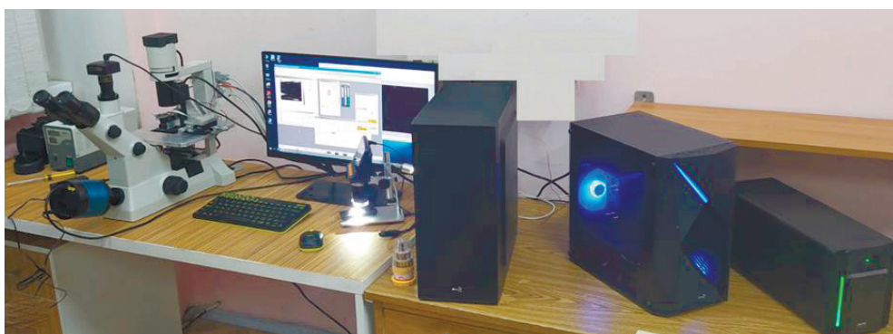
Рис. 7. Общий вид комплекса в Физико-техническом институте НАН Беларуси (основная охлаждаемая CCD-камера 12Mpix, вспомогательная CMOS-камера 5Mpix)
