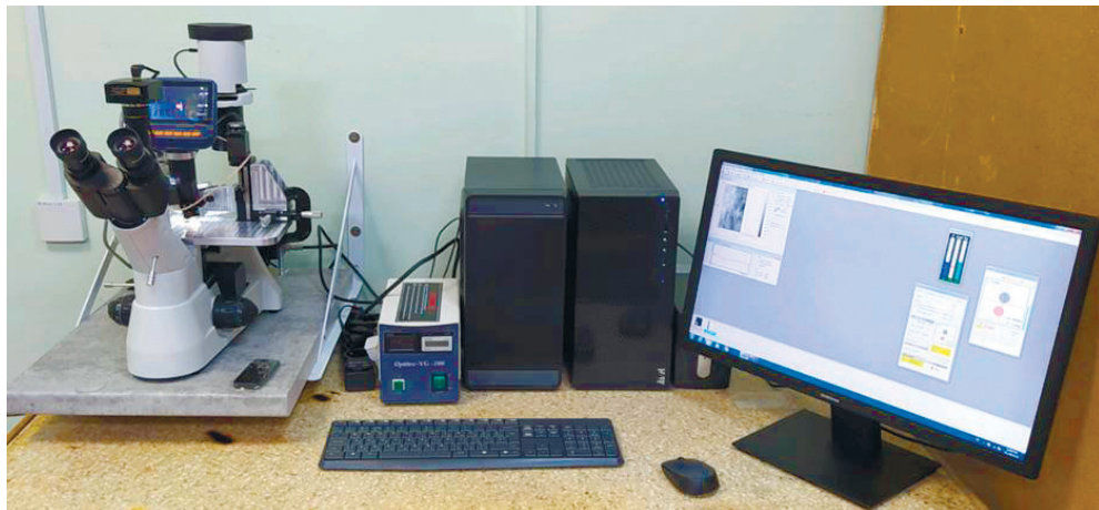
Рис. 5. Общий вид комплекса в Институте прикладной физики НАН Беларуси (установлен дополнительный неинвертированный цифровой микроскоп с большим рабочим отрезком и система подсветки непрозрачных образцов)
